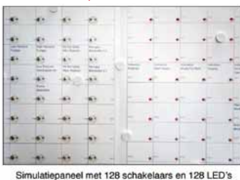
Fig. 3 SIL traject met dynamische simulatie
